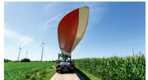
Anlieferung der Rotorblätter auf befestigtem Weg.
