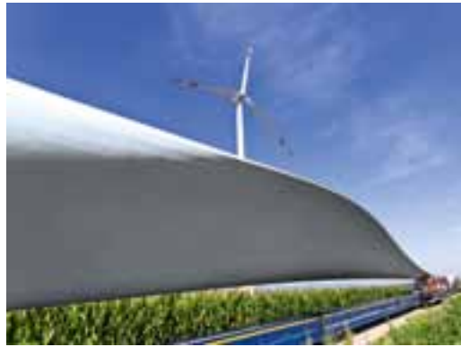
Die Rotorblätter kamen nachts per Sondertransport nach Offenbach an der Queich. Jedes ist rund 60 Meter lang und 14 Tonnen schwer.
